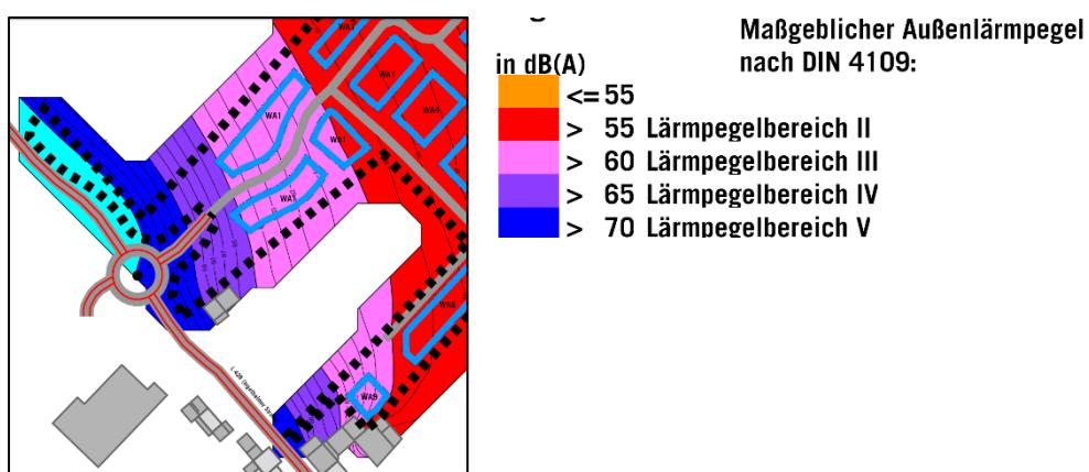
Sofern für die einzelnen Gebäudefronten oder Außenbereiche im Einzelfall geringere Lärmpegelbereiche nachgewiesen werden, beispielsweise bei künftig abschirmender Nachbarbebauung, können für die Außenbauteile entsprechend geringere Schalldämmmaße berücksichtigt werden.
