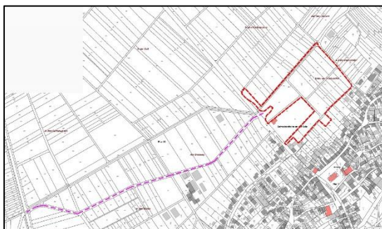
Abbildung 10: Übersichtsplan "Externe Ableitung des Schmutzwassers" (Regioplan)
