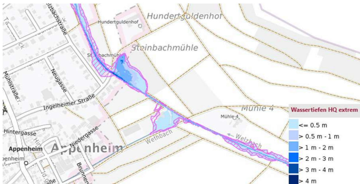
Abbildung 2: Überschwemmungsgefährdetes Gebiet HQ-extrem im Bereich des Plangebietes Quelle: (MKUEM Rheinland-Pfalz)
