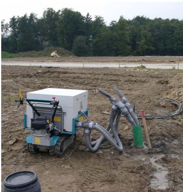
Abbildung A1: Schema eines Geothermal Response Test (GeRT, links) und Durchführung eines Geothermal Response Test mit modernem Gerät von UBeG (rechts)
