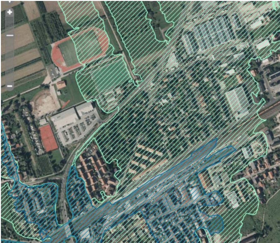
Abb. 6. Hochwassergefährdetes Gebiet (türkis, nachrichtliche Übernahme aus der Gefahrenkarte HQextrem des Landes Rheinland-Pfalz) sowie gesetzliches Überschwemmungsgebiet des Welzbaches (blau); (Quelle: Geoportail Wasser RLP 2016).
