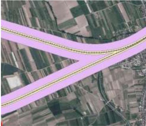
Das EEG schreibt für eine PV-Anlage einen Abstand zum Fahrbahnrand der Schienenwege und Autobahnen von mindestens 20 bzw. 40 m vor. Abbildung 6-10 zeigt einen Ausschnitt des Schienenweges mit ihren zugehörigen Puffern.
